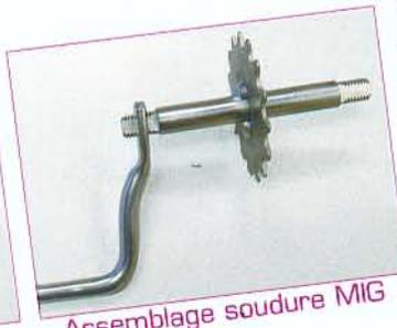
Assemblage soudure MIG
